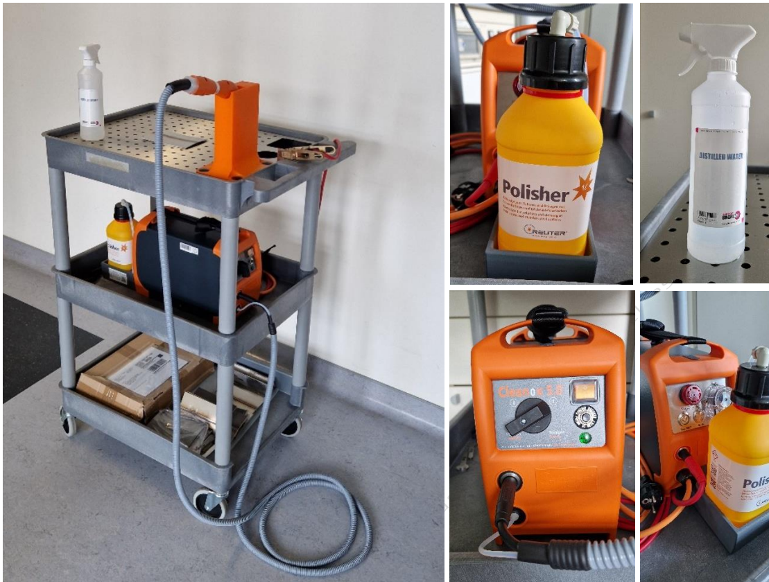
Abb. 1: Mobiler Arbeitstisch (l.), Cleanox 5.0 Gerätevorderseite (u.m.) und Rückseite (u.r.), Polisher Elektrolyt und destilliertes Wasser (o.m., o.r.)
